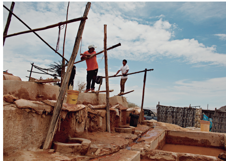
La extracción del oro mediante los quimbaletes es altamente contaminante
