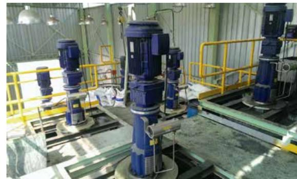
Tanques reactores de lixiviación - planta piloto
