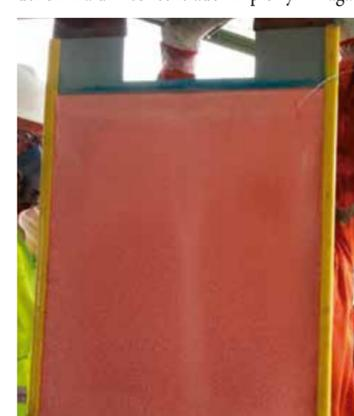
Catodo de cobre obtenido en la planta piloto - Proceso electrowinning
