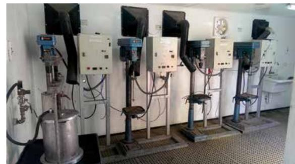
Equipos de lixiviación batch para pruebas a nivel de laboratorio
