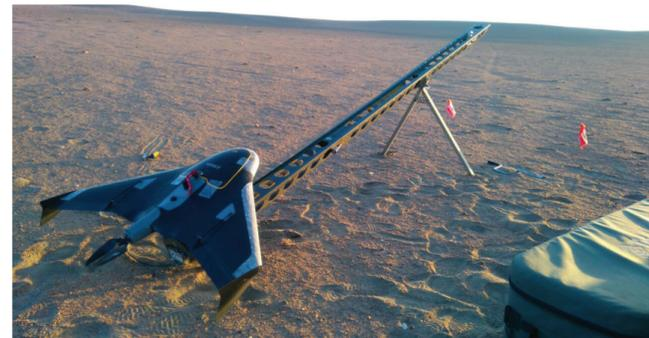
Dron de la empresa Geodrones que permitió obtener en tiempo récord la topografía, mediante levantamiento fotogramétrico, para evaluación y diseño de componentes para la explotación del yacimiento
